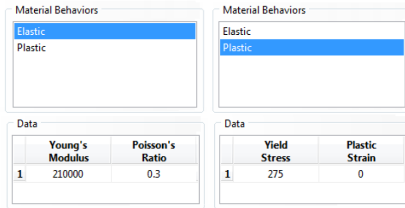
Figura 27. Propiedades del material introducidas en Abaqus
