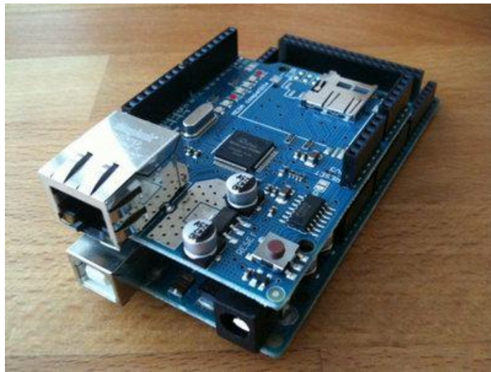
Figura 5.1 Arduino UNO con módulo Ethernet.
