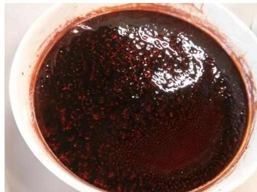
Figura A.21. Sol-gel tras el secado en la estufa.
