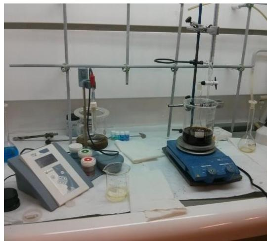
**Figura A.22. Montaje para la síntesis por coprecipitación.**
