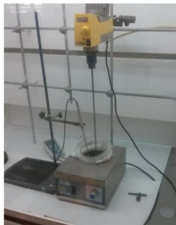
Figura A.20. Montaje para la síntesis sol-gel.
