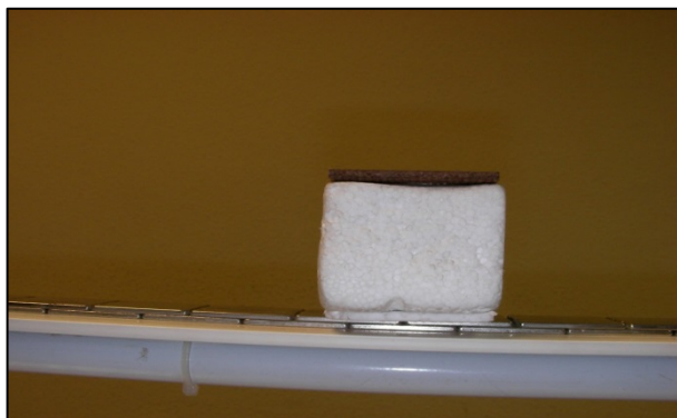
Fig. 16. Caja de poliespan, simulará el vehículo por el carril de imanes.
