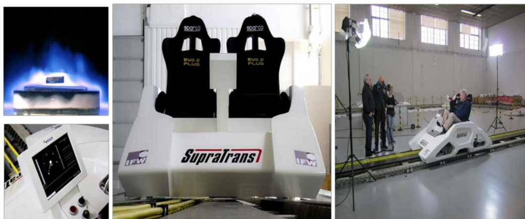
Fig. 18. Supratrans: prototipo de transporte alemán basado en la levitación por atrapamiento de flujo de pastillas SAT de Y-123 sobre imanes de Nd-Fe-B. Para transportes cortos como en aeropuertos. [14]
