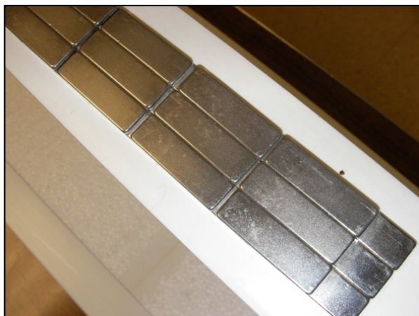
Fig. 14. Detalle de los imanes que forman el carril.
