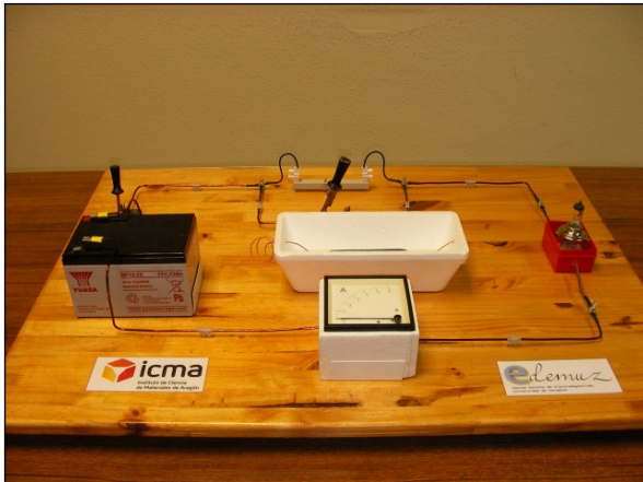
Fig. 10. Circuito principal con el contenedor de poliespan.
