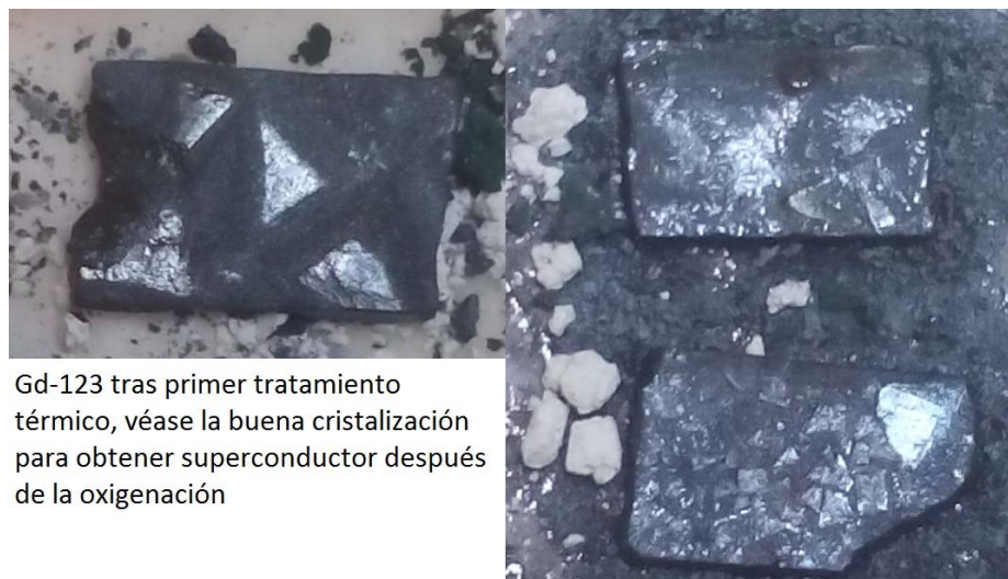
Figura43. Cristales de Gd-123 en monolitos tratados según fig.32.
