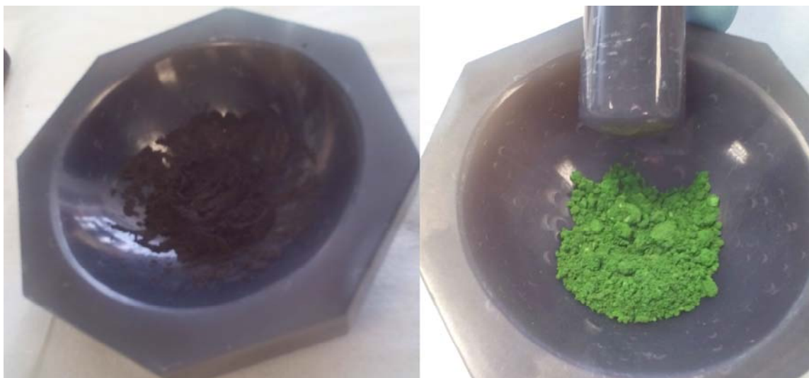
Figura37. Molienda manual en pequeñas cantidades en mortero de ágata, izquierda cuprato y derecha Gd-211
