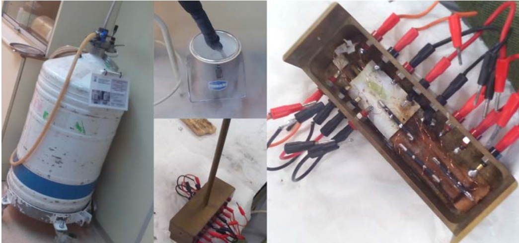
Figura21. Izquierda: Recipiente de almacenaje de nitrógeno líquido (60 litros). Centro superior: Recipiente transporte manual (Dewar) pequeñas cantidades nitrógeno líquido (2 litros). Centro inferior: Dispositivo medición resistividad elementos. Derecha: dispositivo abierto y con muestras superconductoras en forma de barritas.
