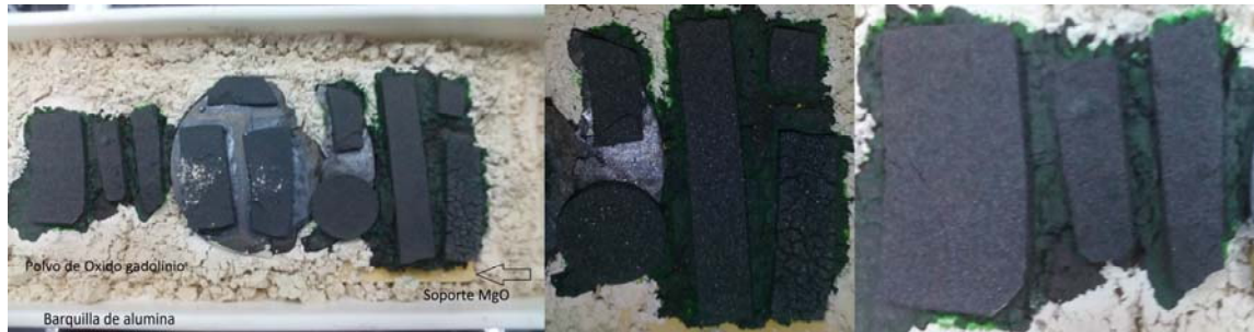
Figura42. Tratamiento térmico principal de muestras Gd-123 (no hay buena cristalización).
