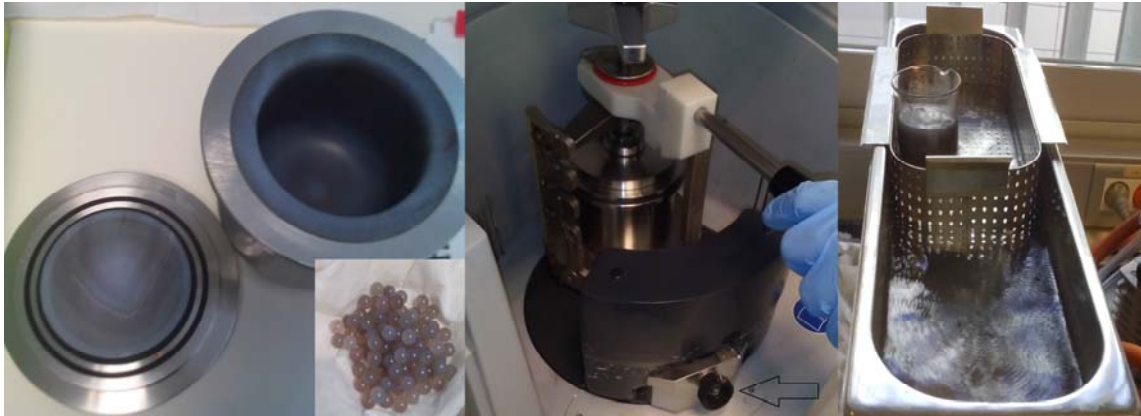
Figura27. De izquierda a derecha: Vaso/mortero y bolas de ágata (recuadro), molino planetario fijense en dispositivo de tarado (flecha) y limpieza por ultrasonidos de las bolas de ágata.
