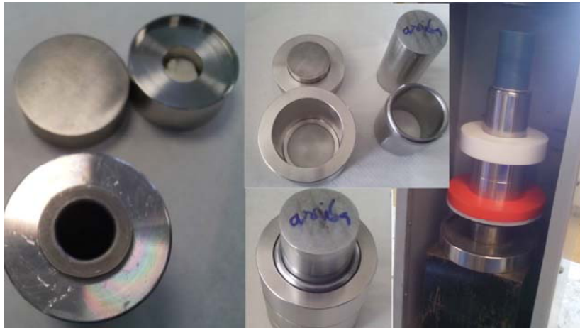
Figura17. MOLDES. Izquierda: detalles molde de 2cms. Centro: molde de 4cms, parte superior desmontado e inferior montado. Derecha: moldes de plástico para desencasquillado en prensa (MEGA KS-15).
