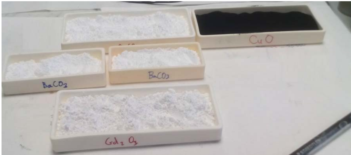
Figura26. Barquillas de alúmina listas para el secado, obsérvese la gran cantidad en \text{BaCO}_3 .
