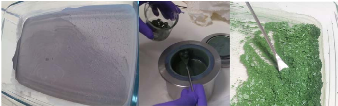
Figura34. Molienda Automática Gd-211. Izquierda: Aspecto durante la primera etapa de molienda, polvo gris claro tras evaporación etanol. Centro: Aspecto durante la segunda etapa de molienda, obsérvese color verdoso del Gd-211. Derecha: Aspecto final.
