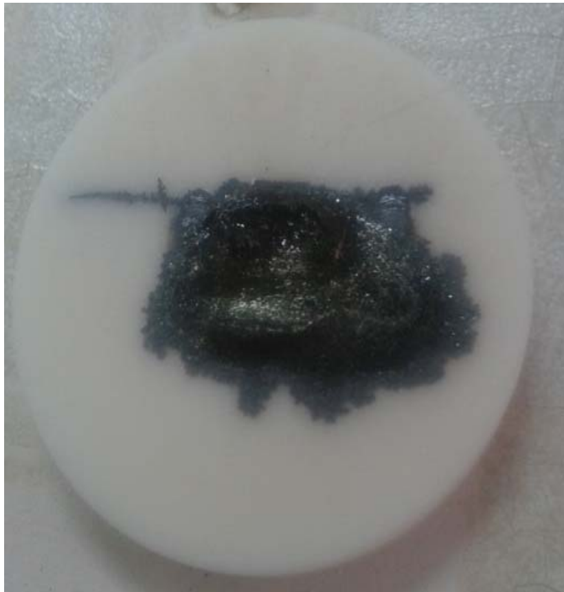
Figura33. Muestra Gd-123 tratado en el horno láser sobre un soporte de Al 2 O 3
