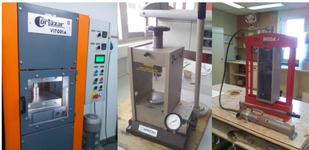
Figura18. PRENSAS. Izquierda: Prensa Cortazar Vitoria con molde de 4 cms en su interior. Centro: Prensa manual Specac para desencapsulado. Derecha: Mega KS-15, para desencasquillado (ver fig.17).
