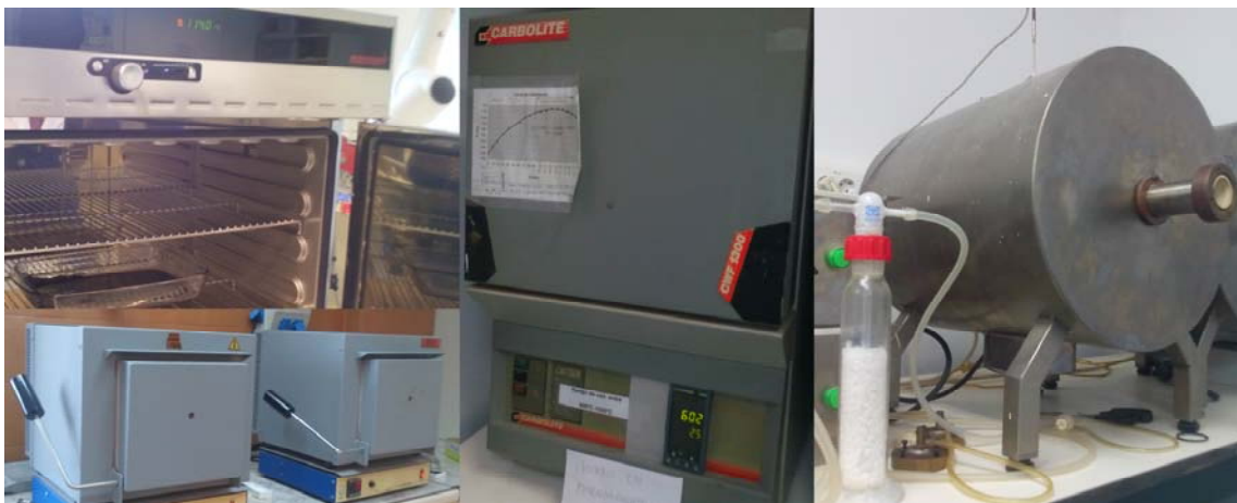
Figura20. Izquierda superior: Estufa de secado Memmert, obsérvese secado de Gd-123, y en la parte superior derecha extractor de vapores de etanol. Izquierda inferior: Pareja de hornos Hobersal. Centro: Horno Carbolite. Derecha: Horno flujo oxígeno, obsérvese filtro de NaOH para agua.
