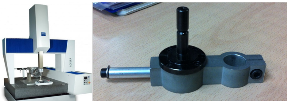
Figura A.4: Ejemplo de MMC y el acople para la nuestra. Fuente: Elaboración propia.
