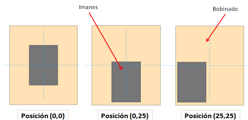
Figura A.5: Posiciones relativas en las que puede encontrarse la matriz de imanes respecto del bobinado. Fuente: NanoPla, documento interno.
