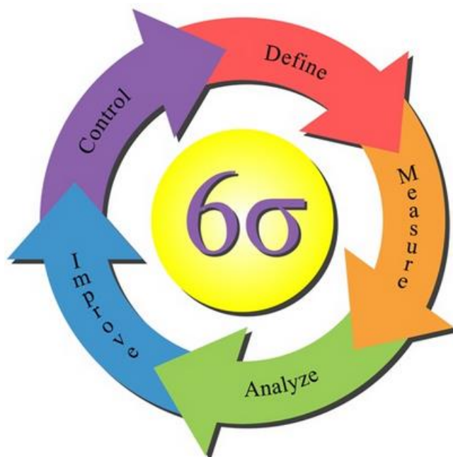
Proceso 6 Sigma: Definir, Medir, Analizar, Mejorar, Controlar Figura 1.4.1
