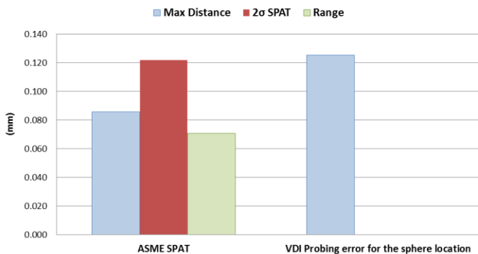
Figura 4.22. Resultados de SPAT y prueba de error de palpado de posición
