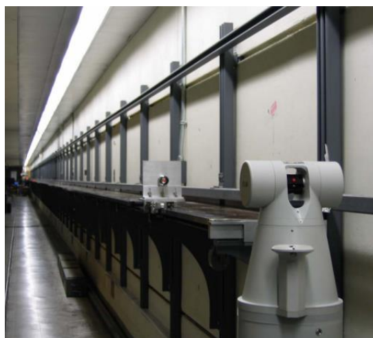
Figura 2.47. Configuración ensayo de medición de longitud según ASME B89.4.19. Fuente: (Phillips, S.D, 2011)
