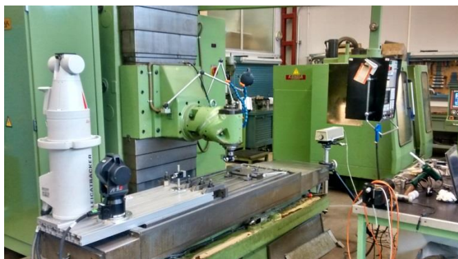
Figura 4.30. Disposición ensayo láser tracker e interferómetro sobre bancada máquina herramienta
