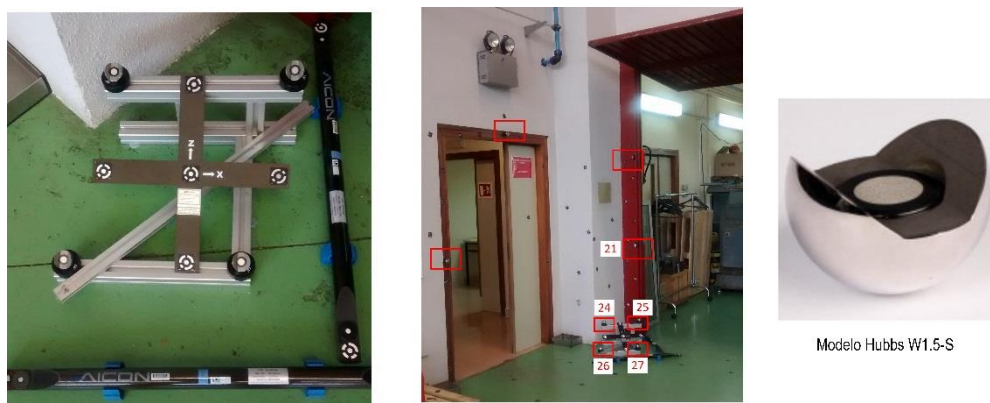
Figura 5.9. Patrones de fotogrametría y disposición en la malla de medición
