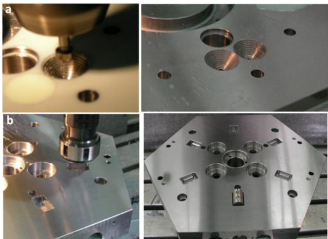
Figura 2.13. Mecanizado de los asientos cinemáticos en la placa móvil para las esferas (a) y en la placa fija para los cilindros (b)
