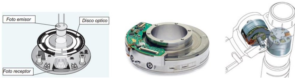
Figura 2.2 Encoders absolutos y posicionamiento de encoders angulares en articulación brazo de medición. Fuente: (Eltra, Heidenhain, Romer)
