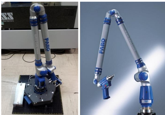
Figura 3.3. Brazo de medida FARO Platinum montado sobre plataforma multi-registro
