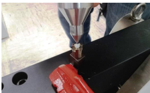
Figura 4.33. Procedimiento de calibración del brazo mediante asiento cinemático.
