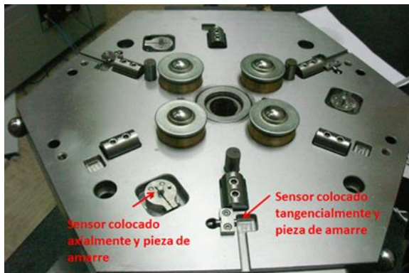
Figura 2.12. Disposición de los sensores capacitivos con sus piezas de amarre a la placa fija.
