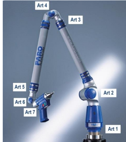
Figura 3.5. Disposición de articulaciones en brazo FARO Platinum
