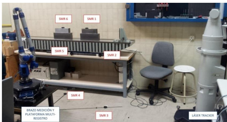
Figura 4.32. Disposición de retroreflectores, brazo articulado de medición y láser tracker en el ensayo
