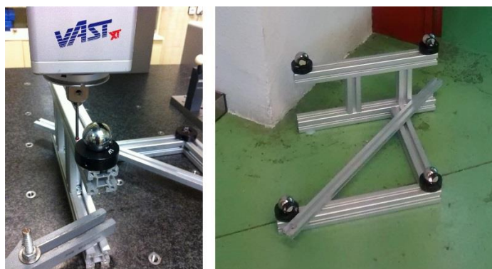
Figura 5.8. Patrón físico con cuatro retrorrefletores y medición del patrón con máquina de medición por coordenadas
