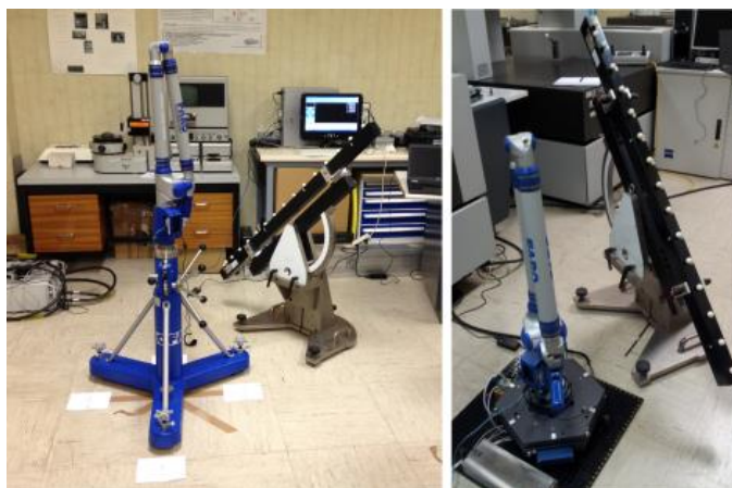
Figura 4.16. Disposición del brazo en ensayos de normativa y brazo con plataforma multi-registro.
