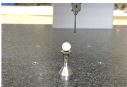
Figura 3.7. Medición de parámetros geométricos iniciales del modelo con MMC
