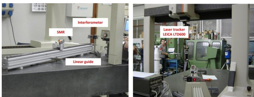
Figura 4.31. Disposición ensayo láser tracker e interferómetro sobre guía lineal
