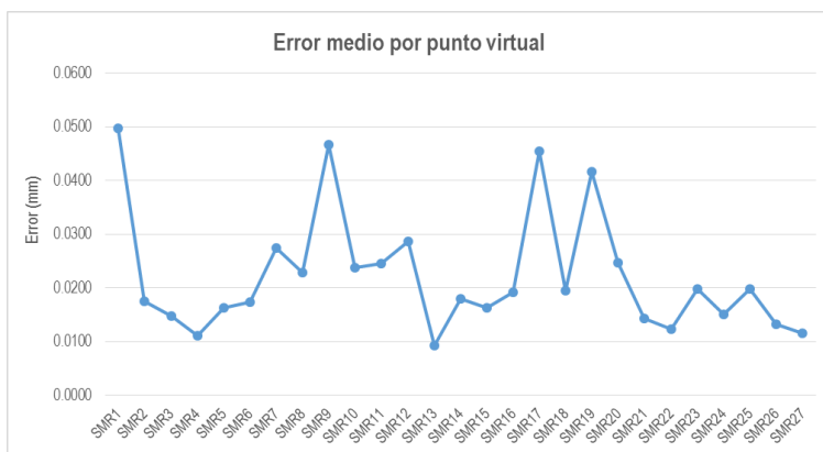
Figura 5.39. Error medio en distancia por puntos virtuales homólogos (método 1)
