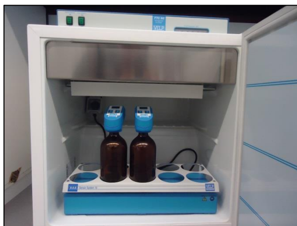
Figura III.1. Biómetros Velp® Scientifica para la determinación de la DBO 5 dispuestos sobre sistema de agitación.
