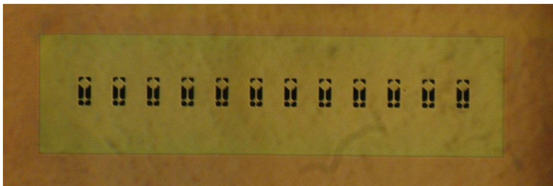
Figura 19.- Fotografía realizada en el microscopio óptico de los portamuestras fabricados en una membrana de \text{Si}_3\text{N}_4 fabricada mediante litografía óptica.
