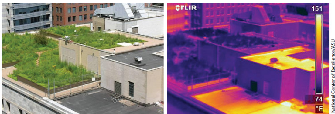
Ilustración 20: Diferencia de temperatura entre cubierta normal y verde( Fuente: EPA, 2013)
