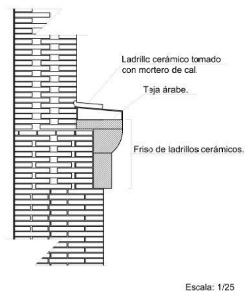
Ilustración 58: Cambio de sección del muro de la torre.
