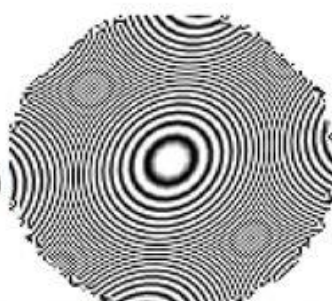
Figura 14, Interferogramas del frente de onda de las lentes monofocales
