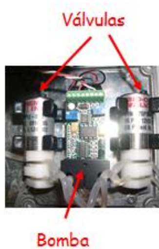
Anexo 2a: Sistema hidrodinámico que consta de dos válvulas de tres vías y una bomba peristáltica.
