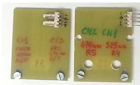
Anexo 7a: De izquierda a derecha: placa A con leds de 420 y 470 nm y placa B con leds de 470 y 525 nm.
