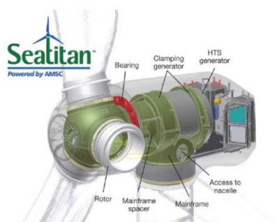
Figura 2: Concepto del aerogenerador superconductor off-shore creado por AMSC. Cortesía del Prof. Alan Wolsky
