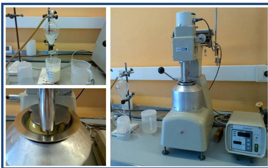
Foto 15_ Preparación amilo y Amilógrafo Brabender. Autora: Arjona, B.
