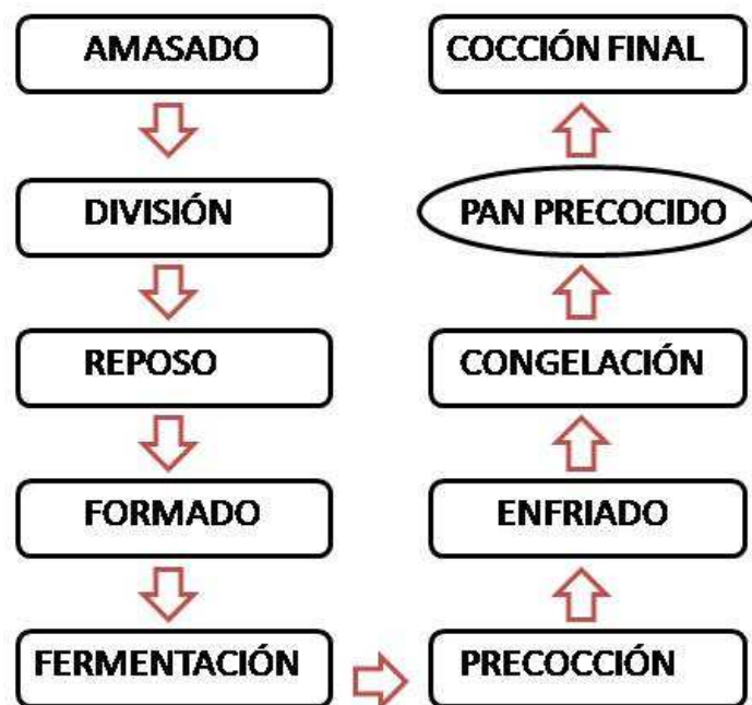
Fig 8_Fases proceso productivo pan precocido. Autora: Arjona, B.
