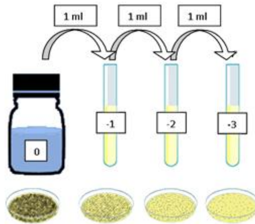
Figura 20. Esquema del método de diluciones seriadas. Fuente: Banco de imágenes del IFSTIC
