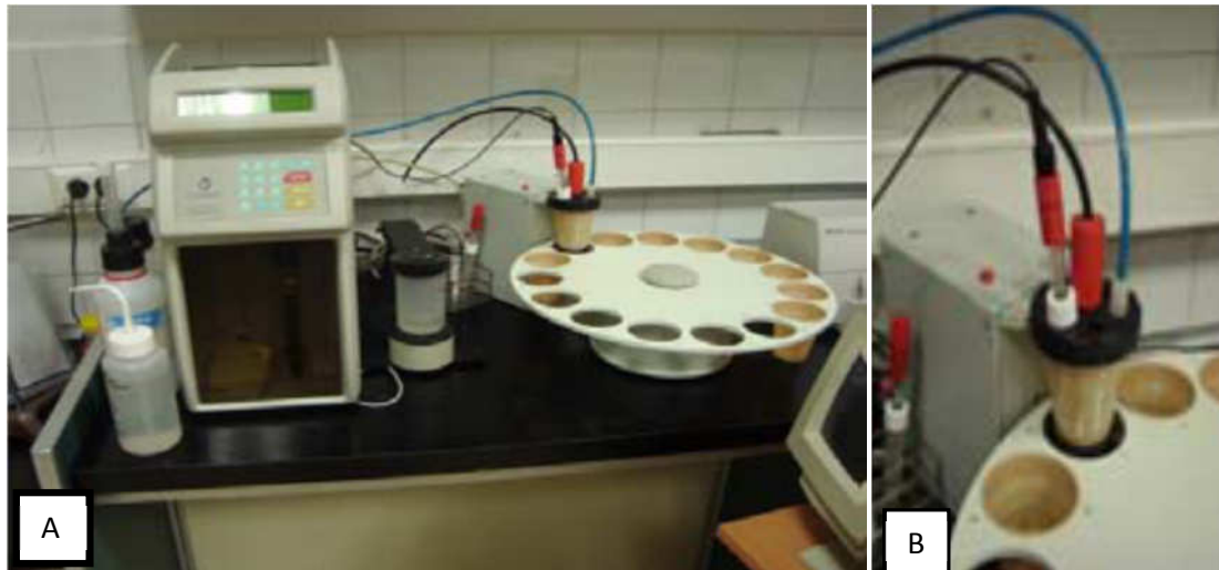
Figura 14. (A) Titulador Crison Compact Titrator y (B) Medida del contenido de la acidez.
