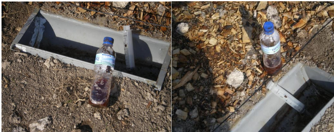
Foto 7.- Recogida de escorrentía y de sedimento.
