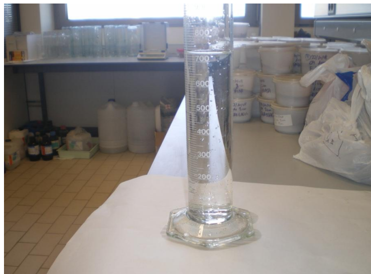
Foto 11.- Medición de la cantidad de escorrentía con la probeta en laboratorio.
