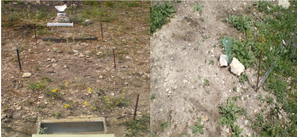
Foto 16.- Totalizador mensual de precipitación (izda.) y pluviómetro (dcha.)
