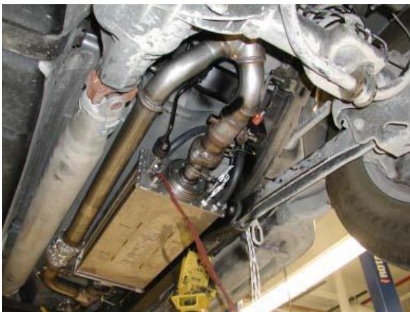
Figuras 9.1.18 y 9.1.19. Vistas inferiores del montaje final del TEG en el Chevrolet Suburban. Se puede ver que se sitúa en la parte posterior muy cerca de la transmisión cardan. Y que en el conjunto se insertan dos tubos negros, uno por cada lado que es por donde entra el fluido refrigerante. [11]
