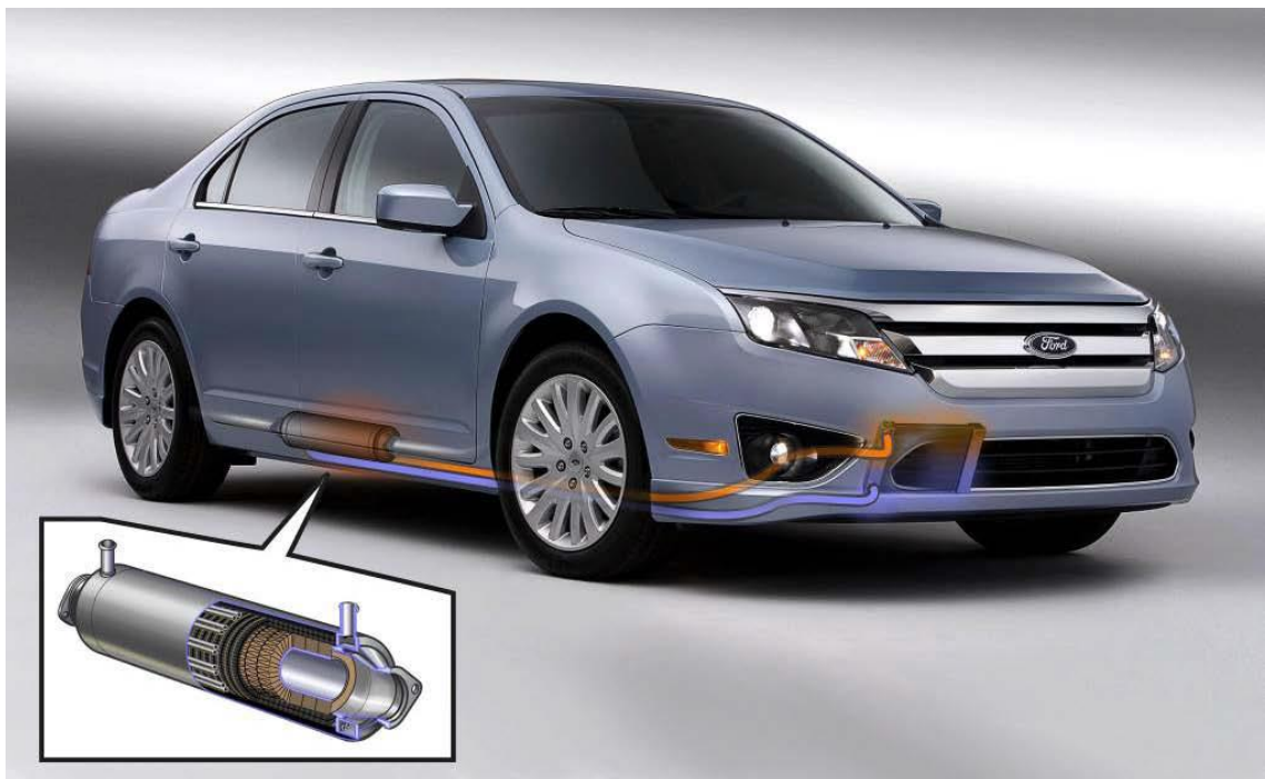
Figura 9.1.20. Esquema de la colocación del TEG en el modelo Fusion de la americana Ford.
