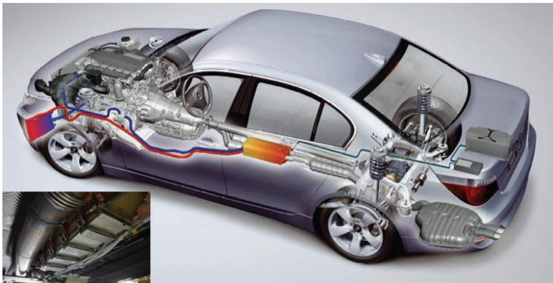
Figura 9.1.2. Primera generación del TEG en el año 2005. Implantación final en el BMW 530i, tipo carrocería E60. [14]
