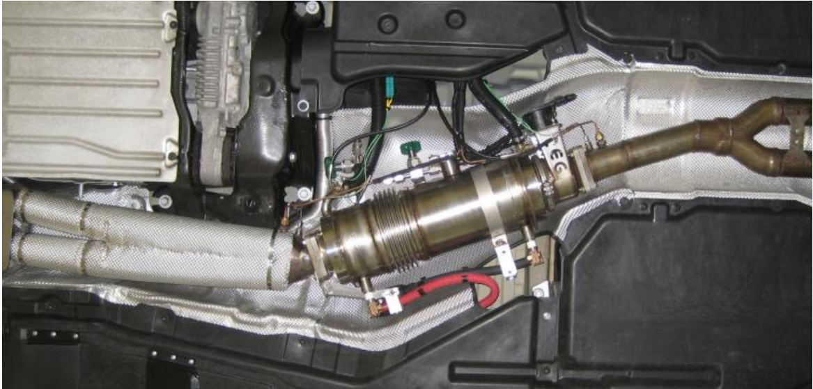
Figura 9.1.9. Vista de planta del BMW X6 donde podemos observar el ya comentado generador termoeléctrico cilíndrico. [9]
