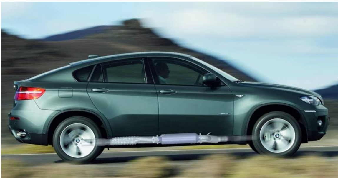
Figura 9.1.8. Implementación en BMW X6 con un termogenerador cilíndrico. [9]
