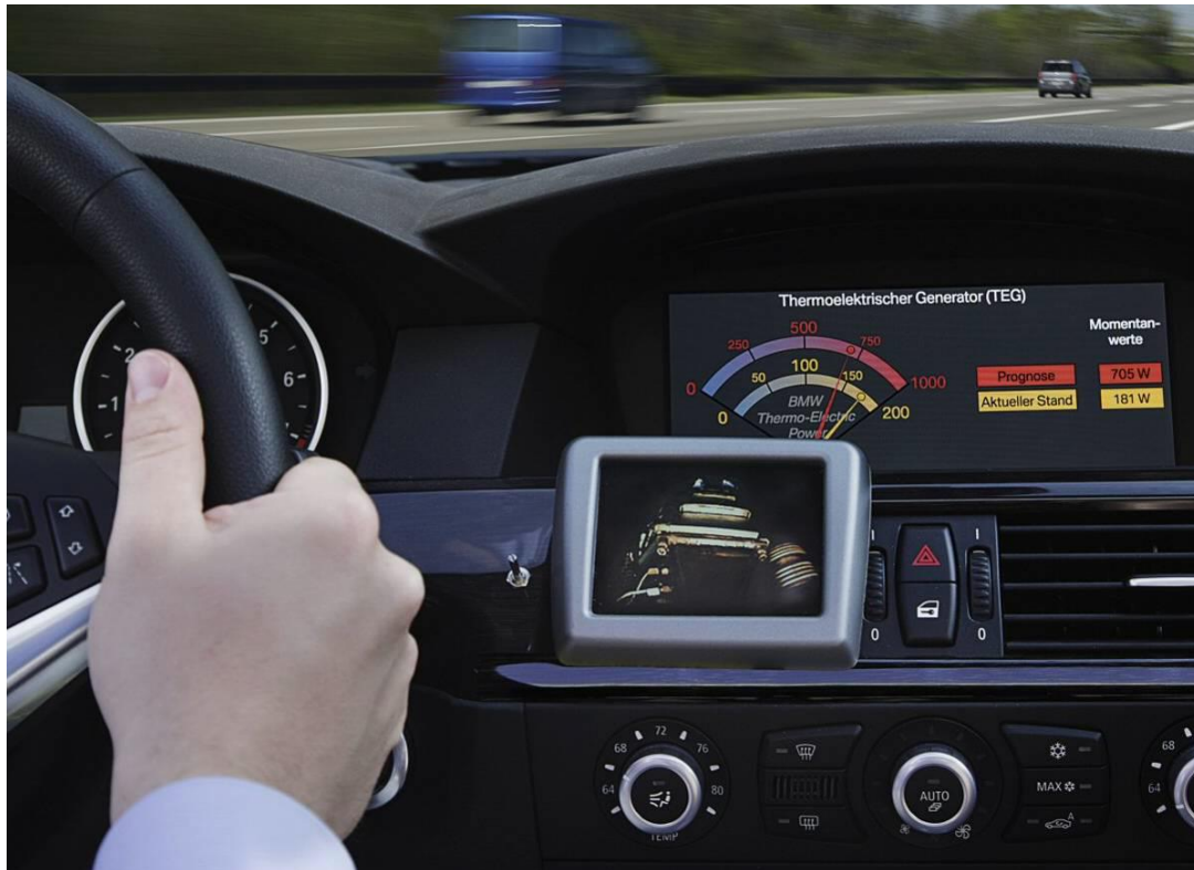
Figura 9.1.3. En esta imagen podemos ver una pantalla instalada para observar en las pruebas el generador termoelectrico y en la consola central la potencia que nos está generando a tiempo real.
