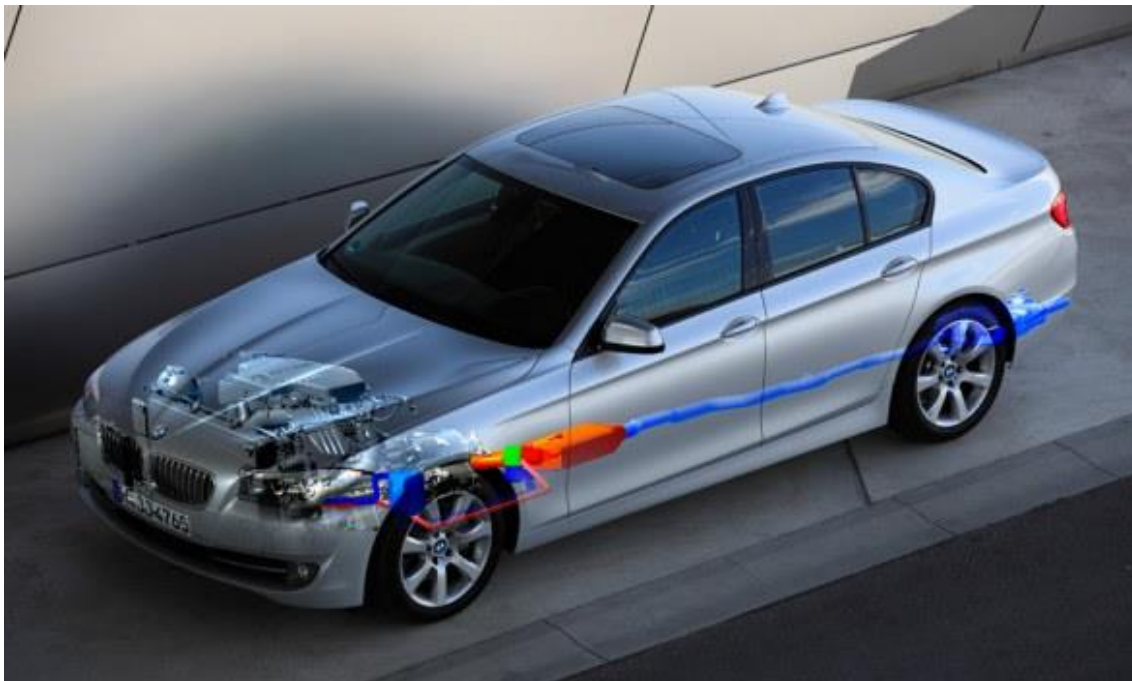
Figura 9.1.4. Última generación de TEG probada en la serie 5 de la marca alemana, carrocería F10. A partir del año 2011. [7]
