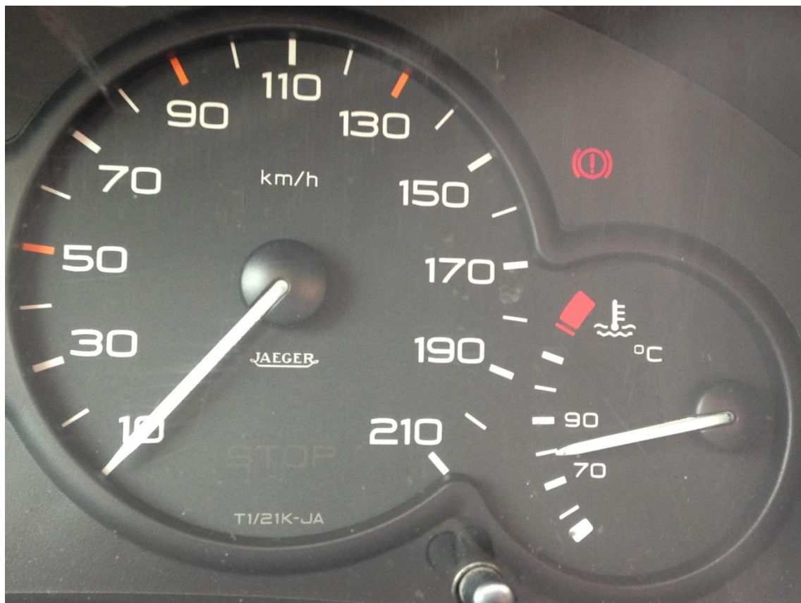
Figura 9.4.4. Imagen donde se justifica la temperatura de 80°C del líquido refrigerante.
