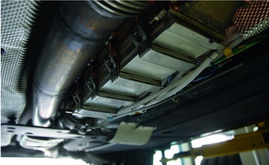
Figura 9.1.1. En esta imagen se puede ver el dispositivo recuperador de calor envuelto por una carcasa metálica protectora. Dispone de baipás regulador. [7]
