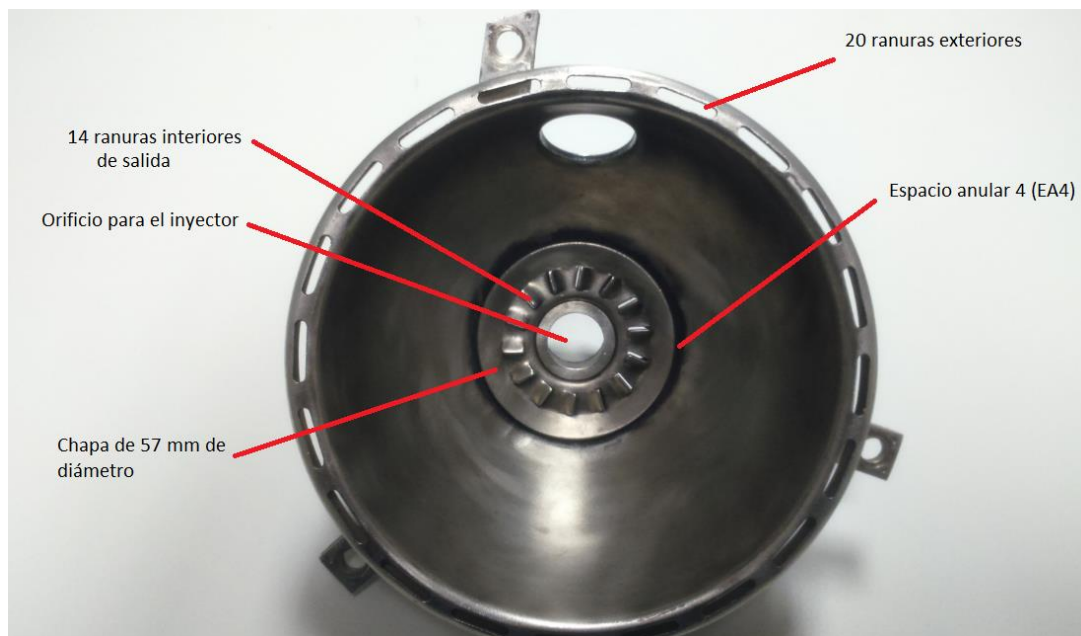
Figura 7 - 4. Sección de entrada del torbellinador de la cámara T33.
