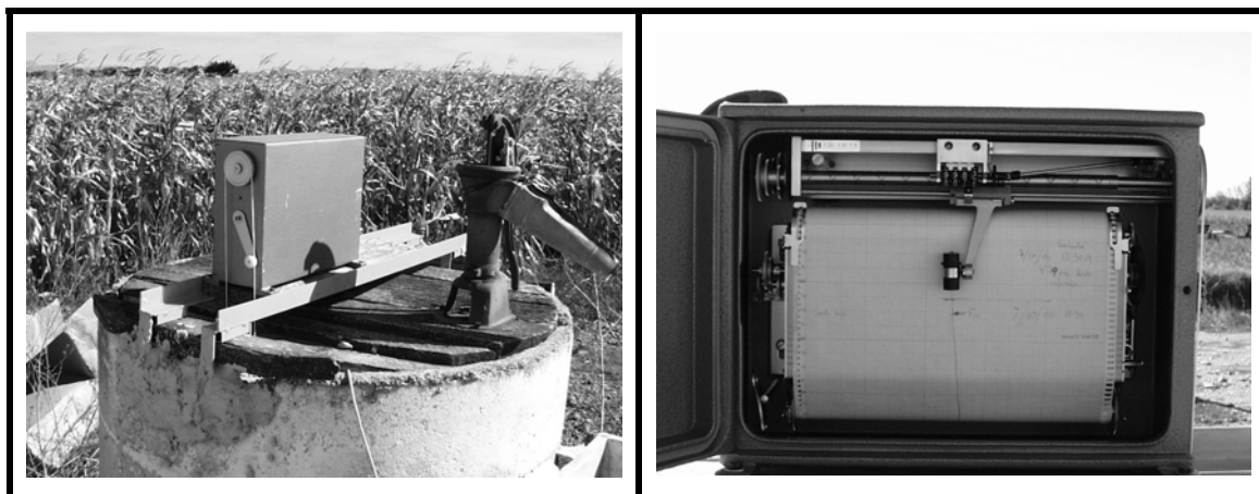
Figura 4.5. Limnógrafo instalado en el pozo P-XXX-1.
