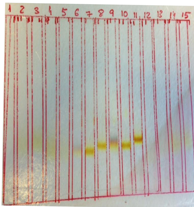
Figura 3.4.9. Gel obtenido con el método SDS-Tris-Glicina-AGE para la caracterización de PC con los patrones de AgNPs
