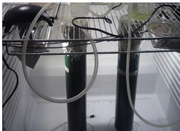
Figura 7.- Estufa de incubación de los cultivos de A. platensis en probetas de 2 L.
