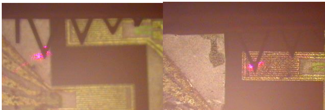
FIGURA 4M: Imagen cantiléver sin deposición (izquierda) e imagen cantiléver con deposición (derecha).
