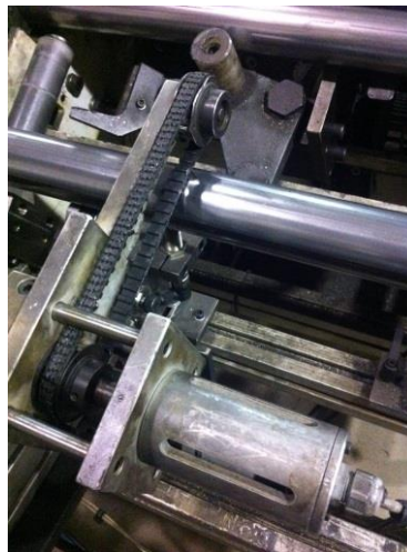
Ilustración 7. Sistema de giro mediante correa
