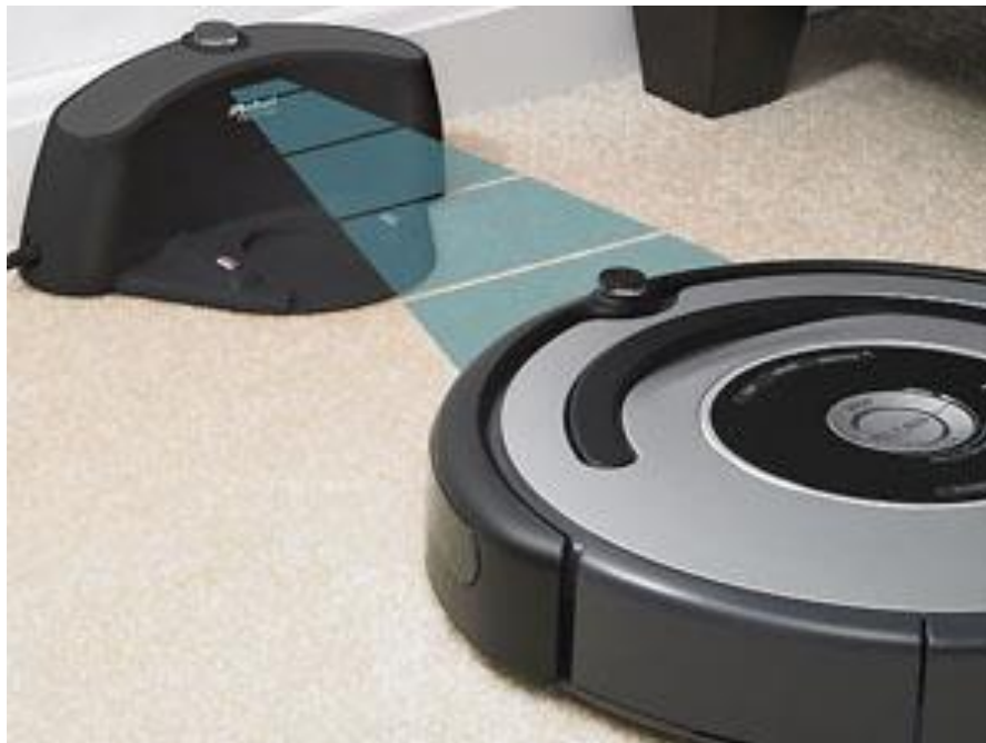
Ilustración 151 Sensor infrarrojo de retorno a la base de carga ("¿Por qué mi Roomba no vuelve a la base de carga?," n.d.)
