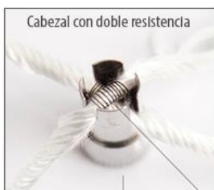
Ilustración 59 Mecha y resistencia de un claromizador ("Partes del cigarrillo electrónico," n.d.)
