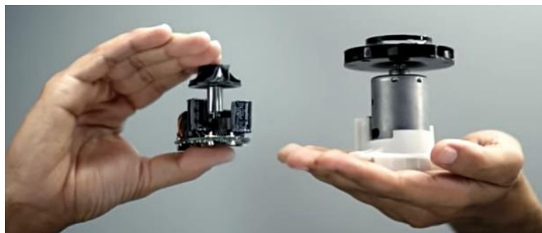
Ilustración 91 Comparativa de tamaño de un motor Dyson con un motor de aspiradora sin cables convencional ( Dyson DC34 - 5 times faster than a Formula 1 engine- Official Dyson video, 2010 )
