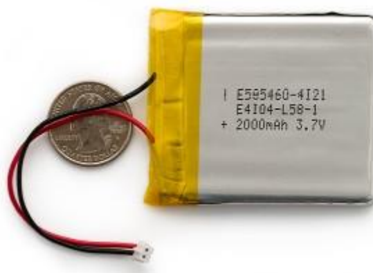
Ilustración 43 Batería Li-Po de un elemento ("Todo sobre las baterías LiPo," n.d.)
