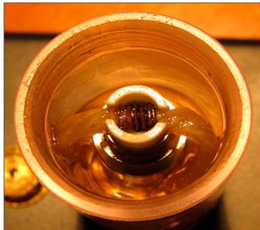
Ilustración 59 Mecha y resistencia de un claromizador ("Partes del cigarrillo electrónico," n.d.)
