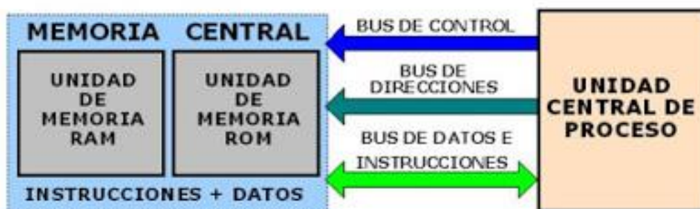
Ilustración 3 (" Arquitectura von Neumann y arquitectura Harvard," n.d. )
