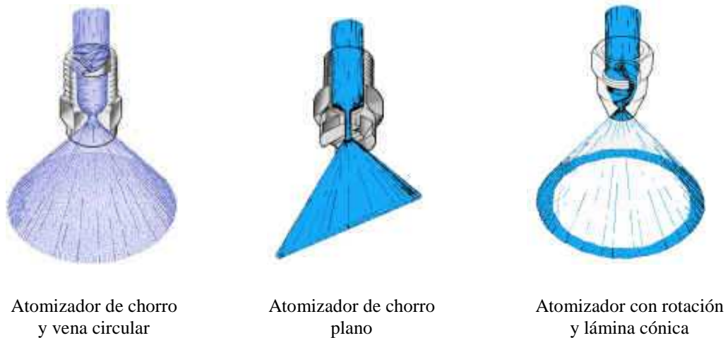
Fig.2-1 Tipos de atomizadores de presión
