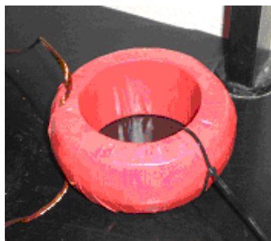
Fig. 107: Bobina de protección a la salida del puente inversor.
