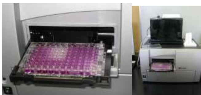
Figura 4.1.8. Espectrofotómetro de análisis colorimétrico.
