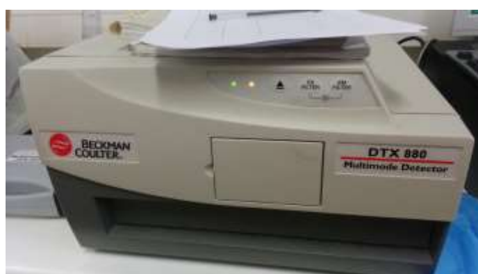
Figura 4.3.2. Medidor de fluorescencia
