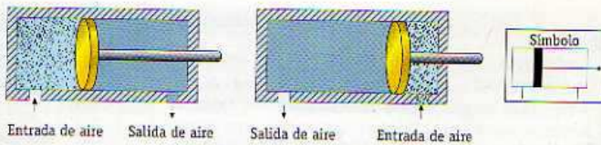
Fig. 16.17. Cilindro de doble efecto.
