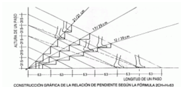
Figura 4.2 Configuración de los peldaños.
