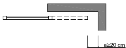
Figura 2.1 Holgura para evitar atrapamientos
