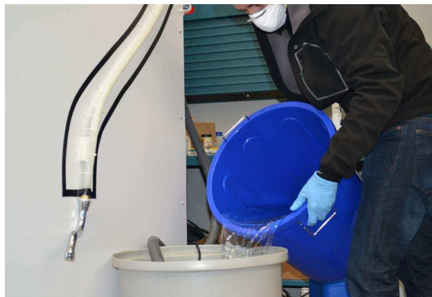
Figura 20. Llenado de agua con Legionella al depósito de recirculación
