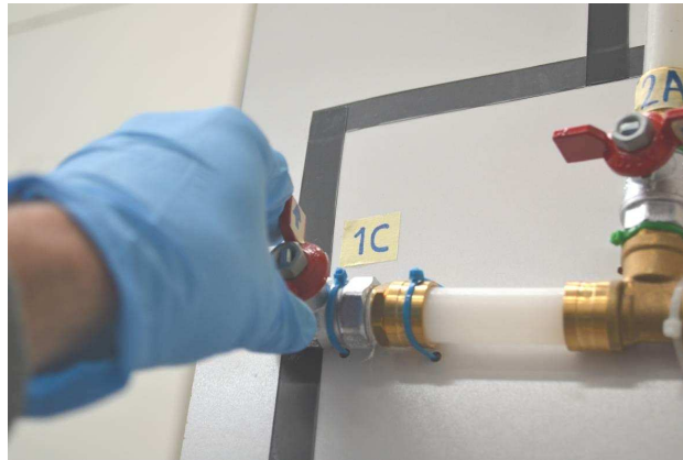
Figura 22. Comprobación purga, llave d1 (Fig.18) posición cerrada C.
