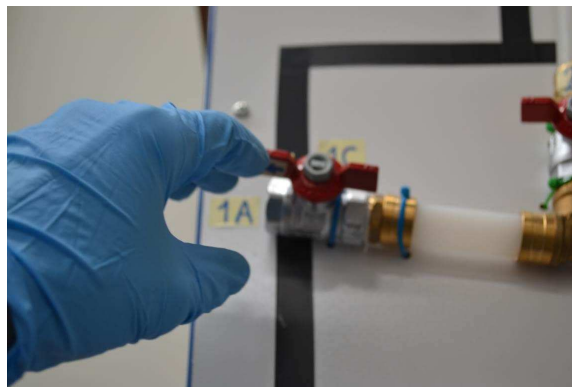
Figura 26. Inicio purga instalación, llave d1 (Fig.18) posición abierta A
