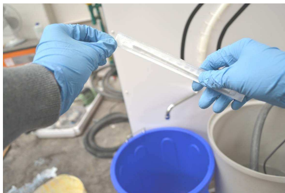
Figura 30. Muestreo interior de punto terminal con torunda estéril
