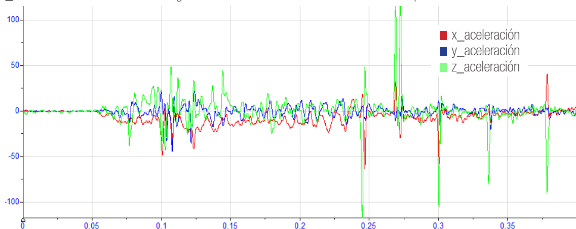
GRÁFICA: Representación de las 3 aceleraciones en función del tiempo
