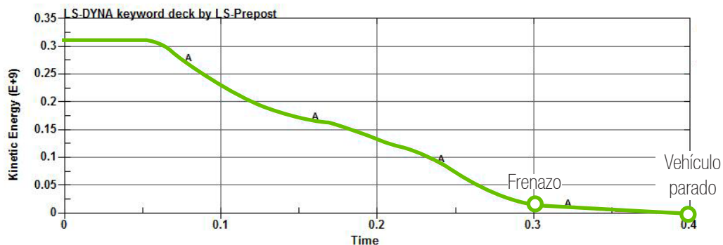
GRÁFICA: Resultado de la pérdida de energía cinética del vehículo durante el impacto
