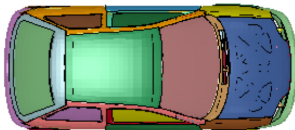
Vista superior. Geo Metro Reducen (16100 elementos)
