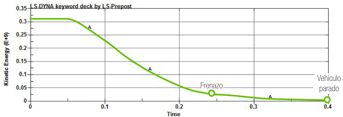
GRÁFICA: Resultado de la pérdida de energía cinética del vehículo durante el impacto
