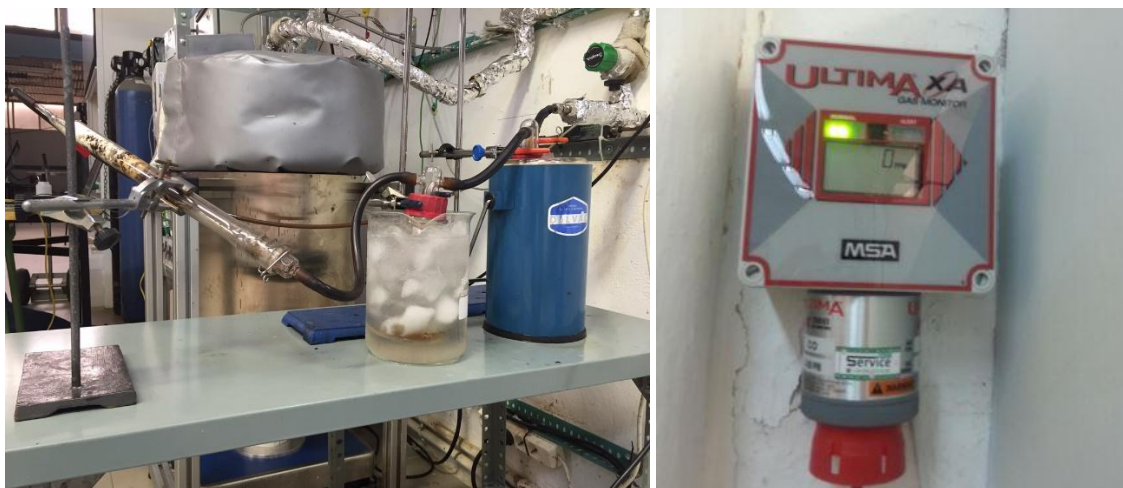
Figura 4.4. Sistema de condensación y analizador de CO
