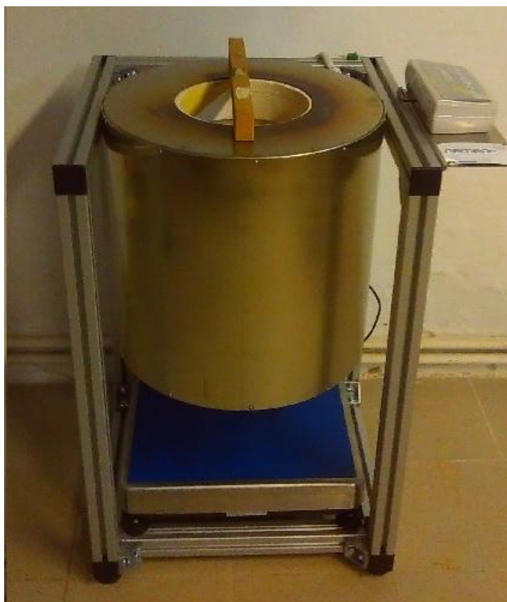
Figura I.2. Horno radiante de alta temperatura
