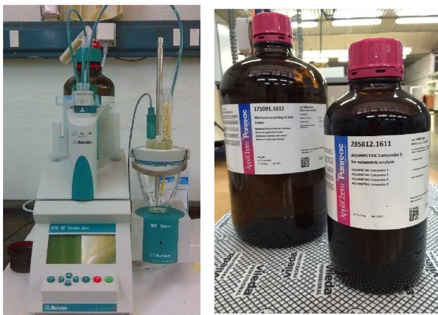
Figura 4.7. Aparato y reactivos para la titulación Karl-Fischer
