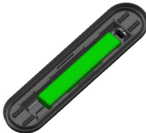
Figura 4.1.7 Interior carcasa con driver LED (verde), conector (negro) y arandela (blanco).
