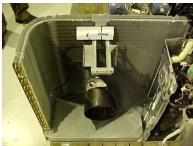
Figura 2. 19 Chasis evaporador Daikin aire-CO 2 con aletas. Fuente: CETIATH [10]
