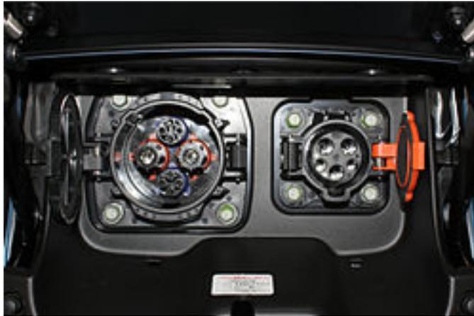
El Nissan Leaf de 2011 y la terminación Visia de 2013 permite hasta 16A en recarga lenta mientras que los modelos de 2013 Acenta y Tekna permiten cargar a 32 A.
