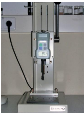
Figura 2.1. Equipo SHIMPO FGE-5X para determinación de dureza de partículas
