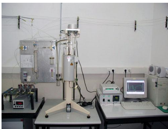
Figura 2.2. Termobalanza CI TG system con sistema de preparación de gases y alimentación de vapor de agua para estudios cinéticos a presión atmosférica.
