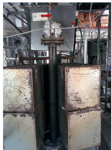
Figura 2.5. Esquema y fotografía de la instalación experimental de lecho fluidizado discontinuo II.
