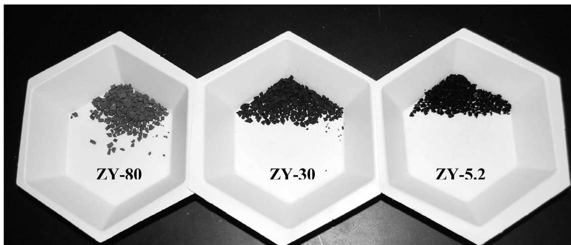
Figura 16: Muestras del catalizador obtenidas tras la reacción para ZY-80, ZY-30, y ZY-5.2.
