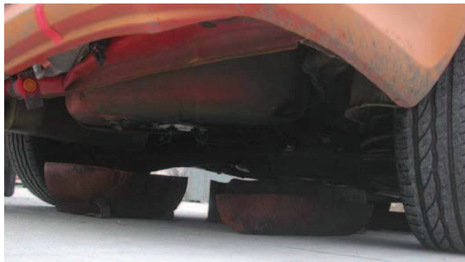
Figura 7: bandejas llenas de gasolina debajo del vehículo.
