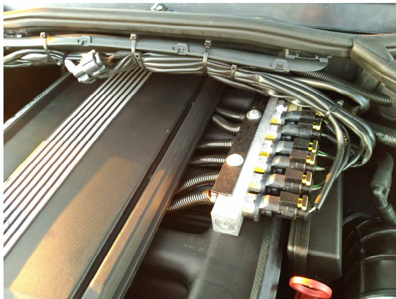
Ilustración 5.23 Detalle del montaje de la rampa de inyectores.
