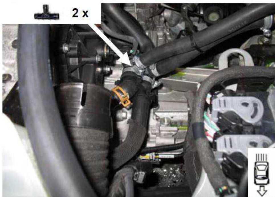
Ilustración 5.21 Conexión de tubos de impulsión y retorno de refrigerante al circuito original del vehículo mediante piezas en T.
