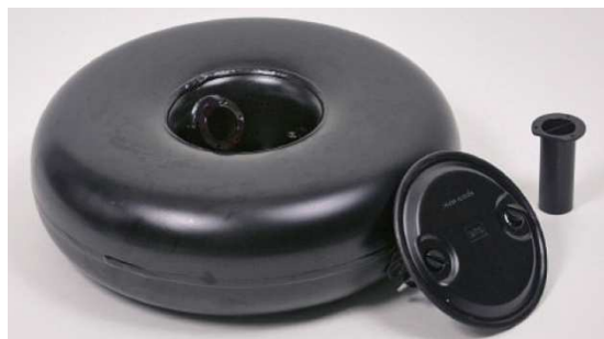
Ilustración 5.5 Depósito toroidal con virola central. Homologación E20*67R01.
