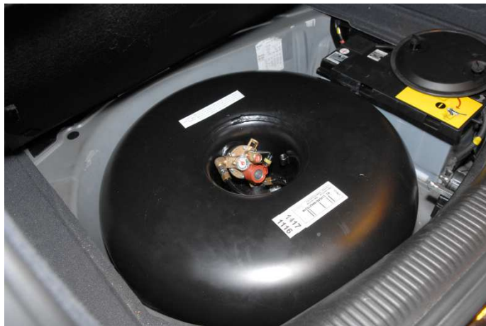
Ilustración 5.6: Depósito toroidal con multiválvula instalada y tapa estanca depositada sobre la batería del vehículo.
