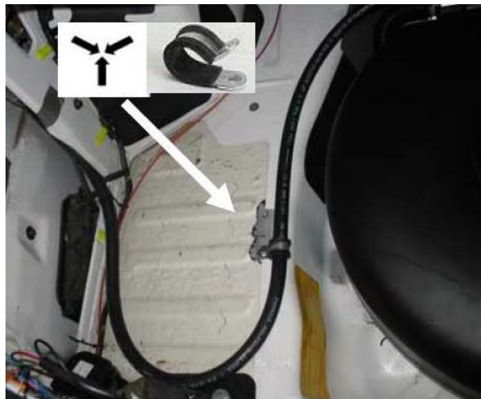
Ilustración 5.20 Fijación de la manguera a la carrocería.
