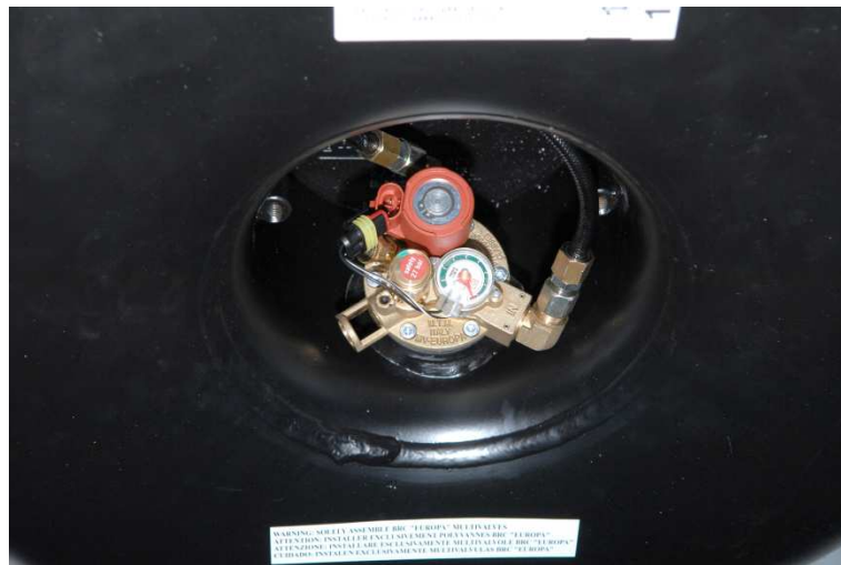
Ilustración 5.7: Detalle de multiválvula instalada en depósito.
