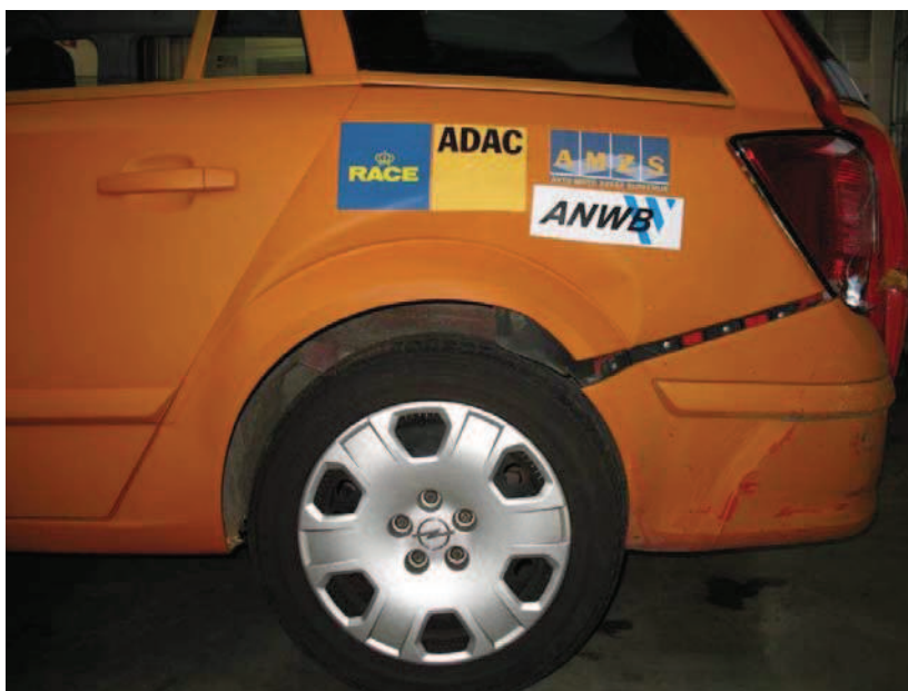
Figura 5: vista lateral del Astra deformado.
