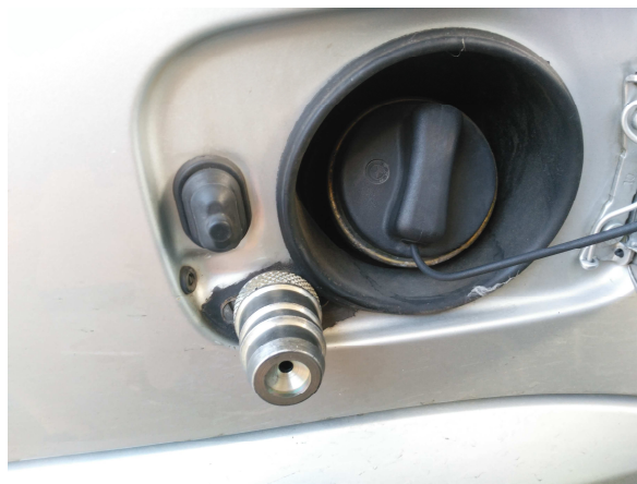
Ilustración 4.3 Boca de carga de GLP con adaptador roscado junto a boca de gasolina original.
