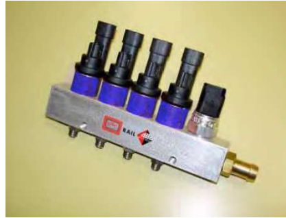
Ilustración 5.14: Raíl de inyección con sensor de Temperatura y Presión incorporado
