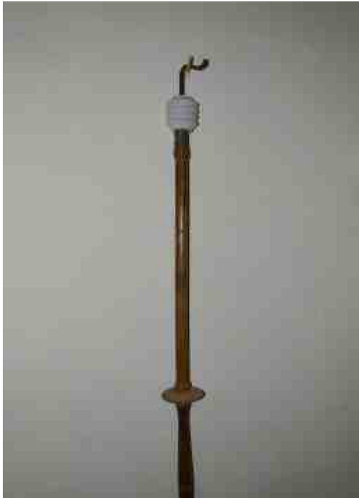
Barra de madera utilizada para accionar los interruptores
