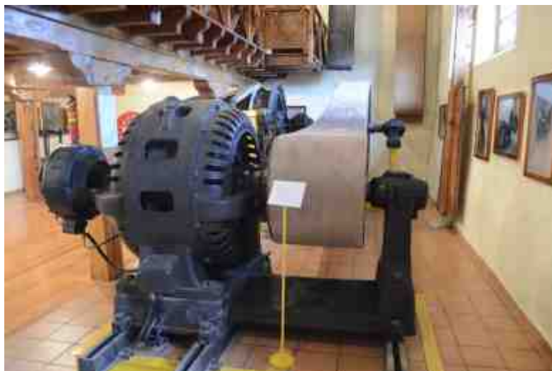
Transmisión de la turbina al alternador
