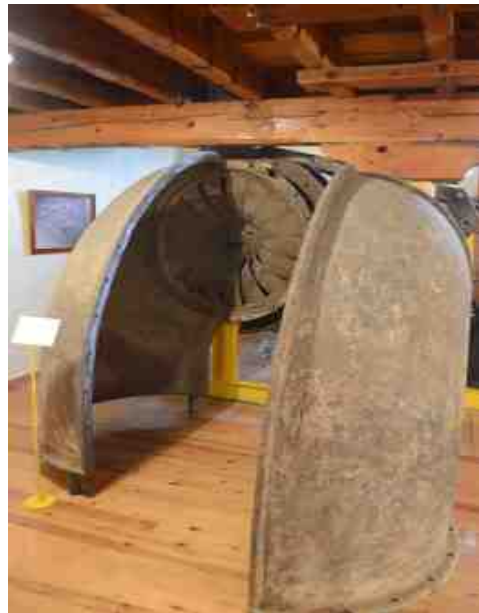
Salida de agua de la turbina
