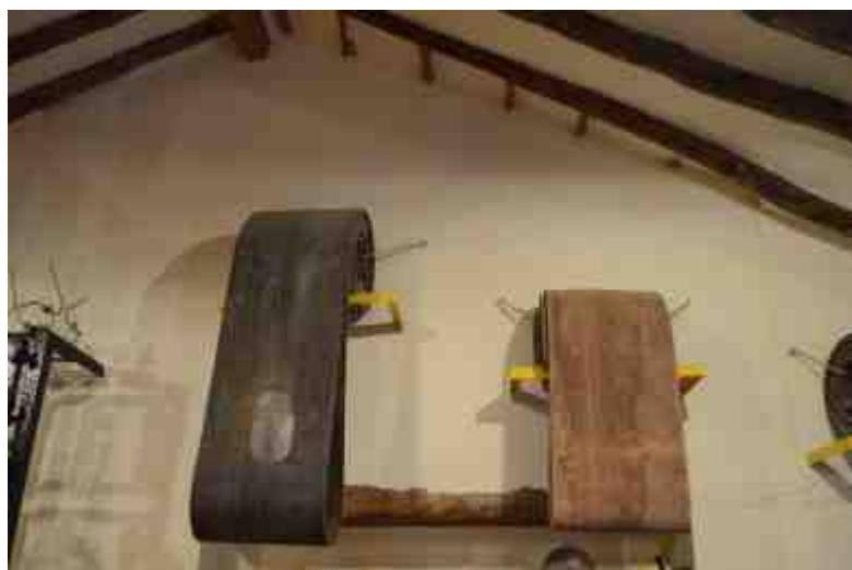
Dos tipos de correas: izquierda camello y derecha cáñamo
