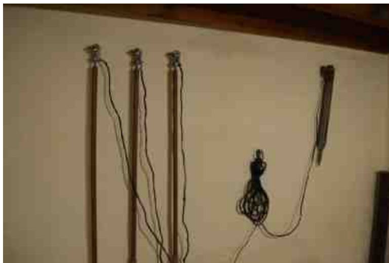
Toma de tierra utilizada para derivar la corriente en reparaciones de las líneas de transmisión a los pueblos
