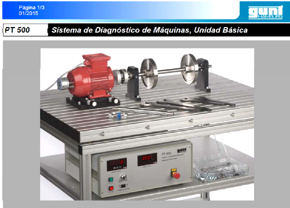
La ilustración muestra el sistema básico PT 500, preparado para los ensayos, junto con el bastidor móvil PT 500.01.
