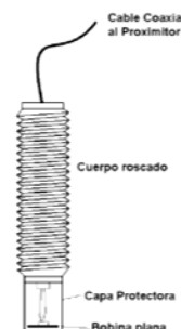
Figura 3.20: Esquema general de un sensor de proximidad.
