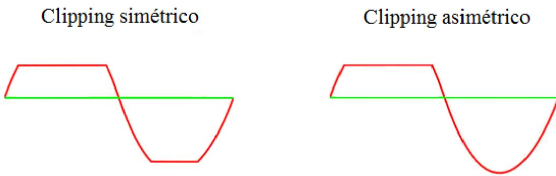
Ilustración 16: Clipping simétrico en una senoide
