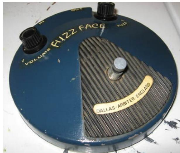
Ilustración 24: Fuzz Face con transistores de silicio
