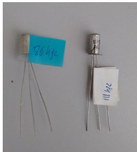
Ilustración 67: Transistores AC125 utilizados en el prototipo
