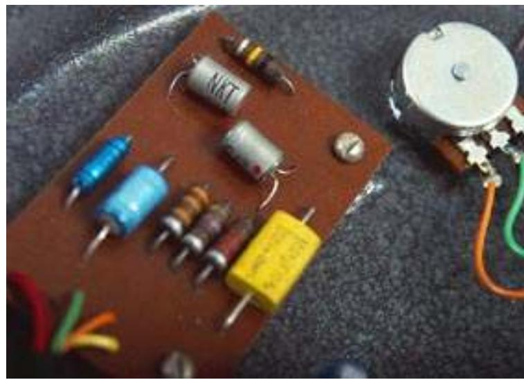
Ilustración 23: Interior de un Fuzz Face de 1967, con transistores NKT 275
