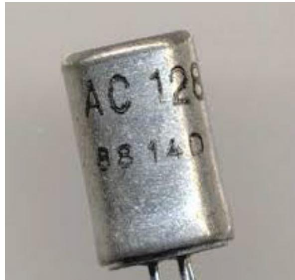
Ilustración 22: Transistor AC 128
