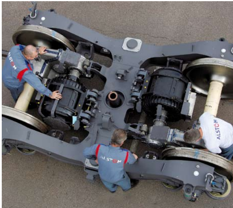
Figura: [95]; Bogie con motores de imanes permanentes. Fuente: [Alstom]
