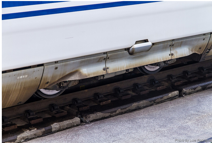
Figura: [53]; Detalle de la cubierta sobre las ruedas para absorber ruido en un shinkansen N700. Fuente: [japonismo.com]
