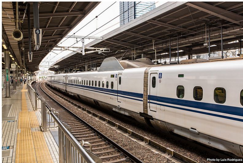
Figura: [56]; Detalle del pantógrafo apantallado para absorber ruido en un shinkansen N700.
