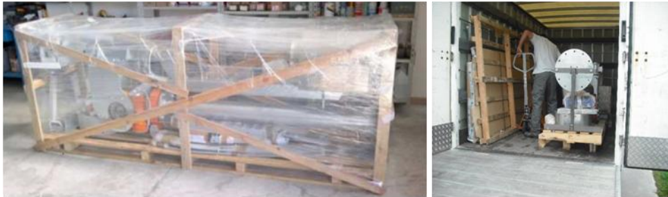
Figura 35: Embalaje acordado con un palet enfardado (izquierda), embalaje recibido sin enfardadar y protegido únicamente por una caja de cartón (derecha).
