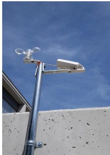
Figura 34: Instalación del anemómetro y del sensor de lluvia.
