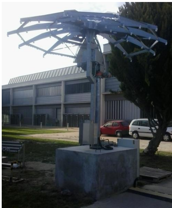
Figura 49: Estructura del sistema de Disco Stirling Trinum.
