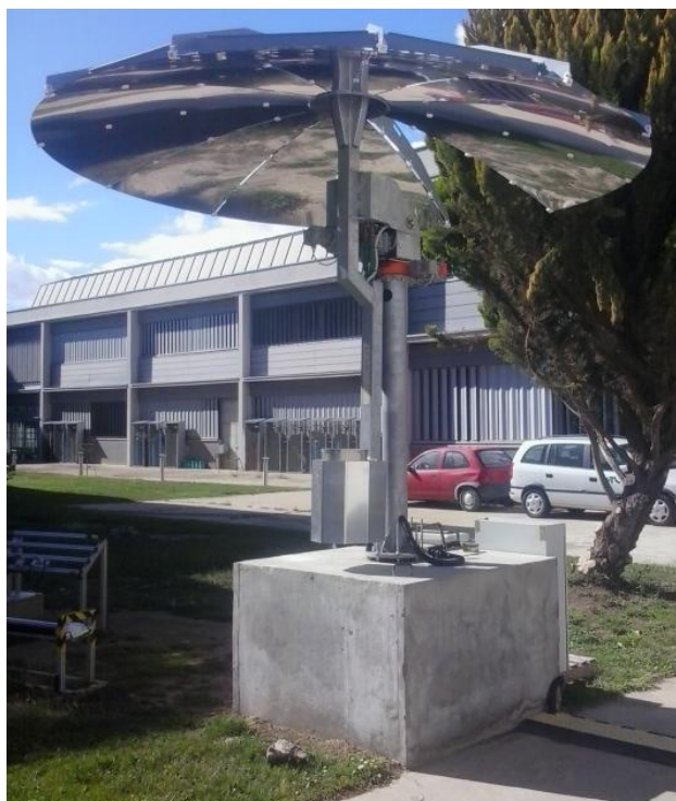
Figura 50: Sistema de Disco Stirling con los reflectores montados.
