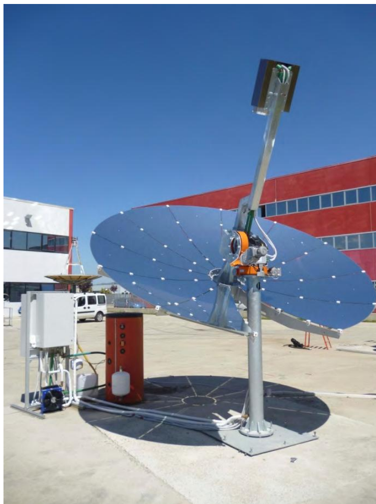
Figura 11: Sistema de disco Stirling montado sobre placa metálica.
