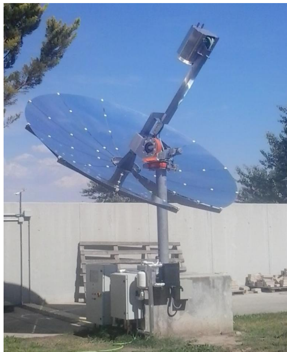
Figura 51: Sistema de disco Stirling Trinum totalmente montado.
