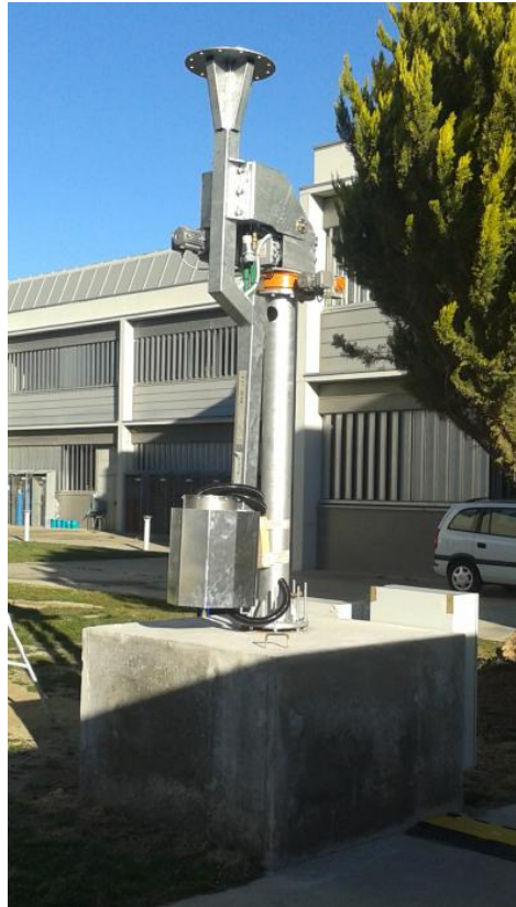
Figura 48: Mástil del sistema anclado sobre el dado plegado en la posición de seguridad.
