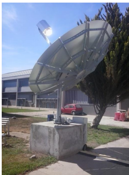
Figura 64: Sistema de disco Stirling Trinum focalizado.
