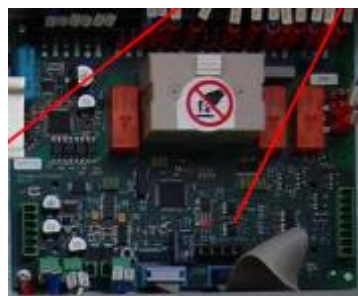
Figura 10: Placa de control del motor Stirling.
