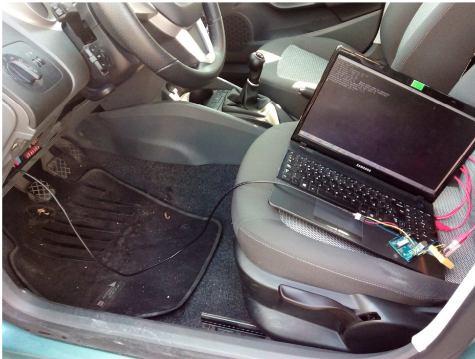
Figura 29. Visualización de los datos del coche en el ordenador usando la placa Arduino.
