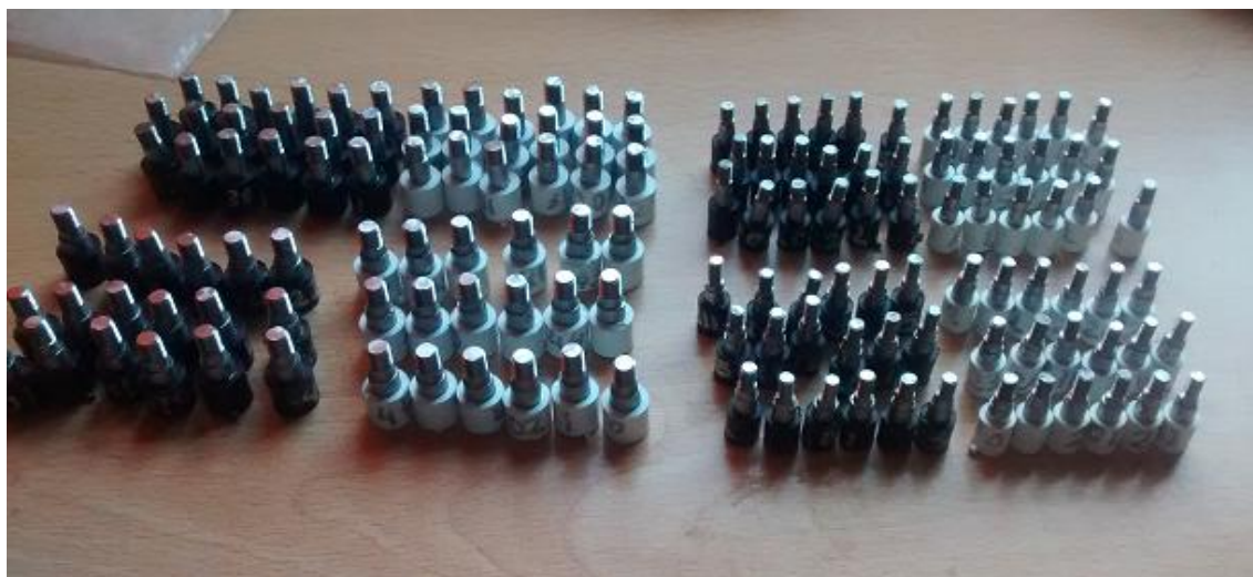
Imagen 39. Conjunto de piezas inyectadas antes de realizar los ensayos de tracción
