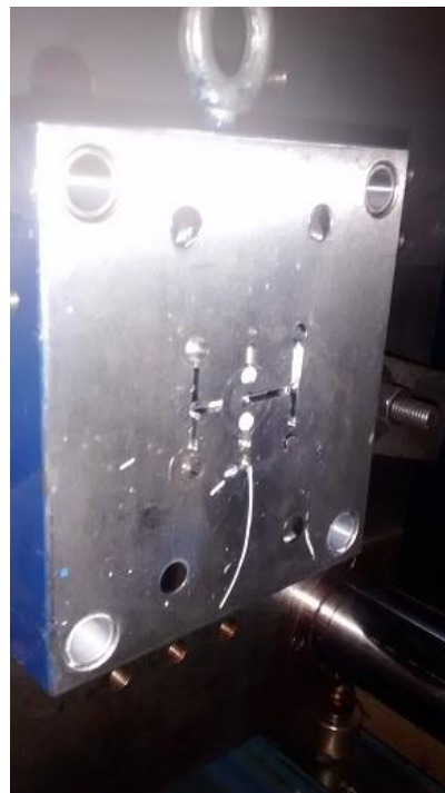
Imagen 32. Placa fija con el canal tapado para inyección
