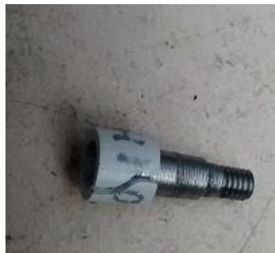
Imagen 47. Fractura con el material ABS
