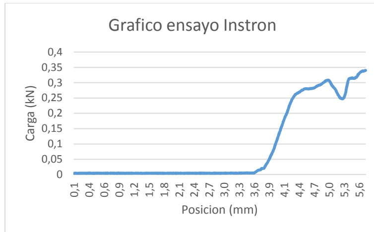
Imagen 46. Grafica de la fuerza de expulsión obtenida en la maquina instron
