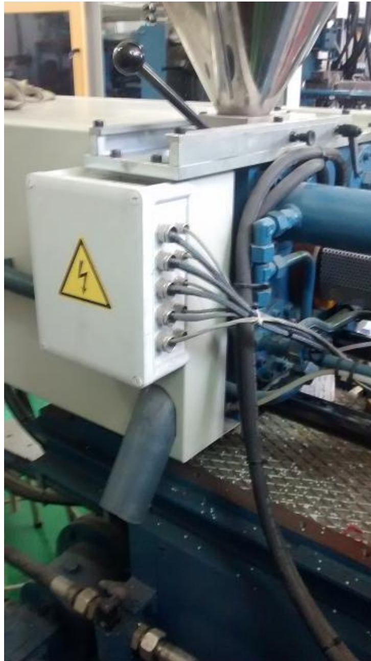
Imagen 31. Conducto de salida para vaciar la máquina de material
