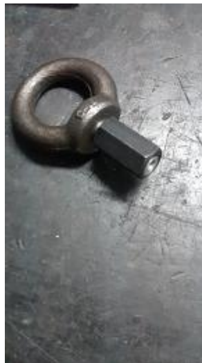
Imagen 41. Fotografía cáncamo y tuerca hexagonal para piezas roscadas M3
