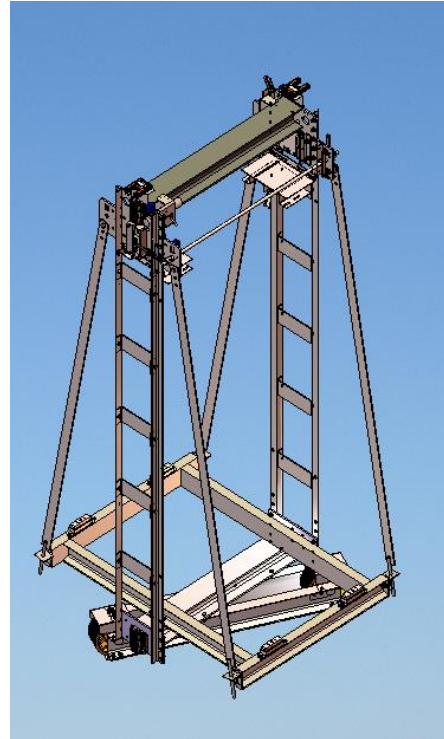
Dibujo 8. Ejemplo Chasis Pórtico.
