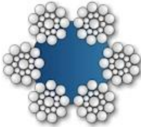
Dibujo 29. Descomposición cable SEALE 6x19+1
